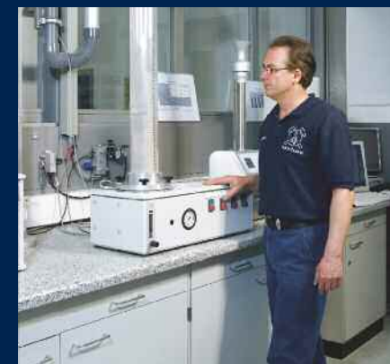
HAVER物料排气能力测试
