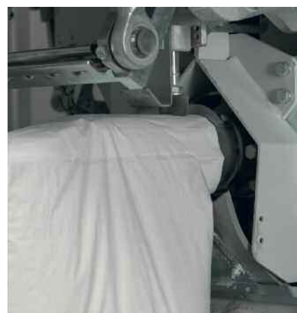
填充过程中的溢洒回收装置
